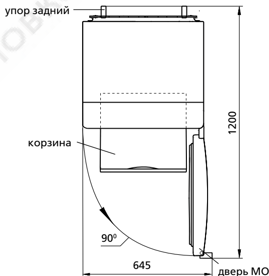
Рисунок 2 – Холодильник (вид сверху)
